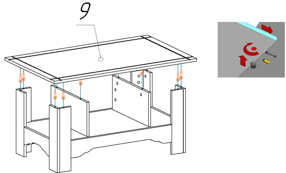
4. На эксцентриковые стяжки крепим фальшфасад (10).
