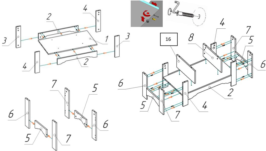
3. Саму столешницу (9) при помощи шкантов и стяжек эксцентриковых крепим к стоевым (3,4,6,7,16).
