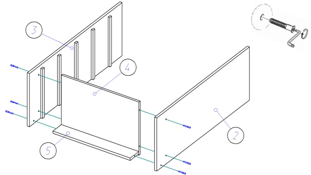
4. При помощи стяжек эксцентриковых и шкантов 8\*30 крепим крышку (1) к бокам (2,3), как показано на рисунке.
