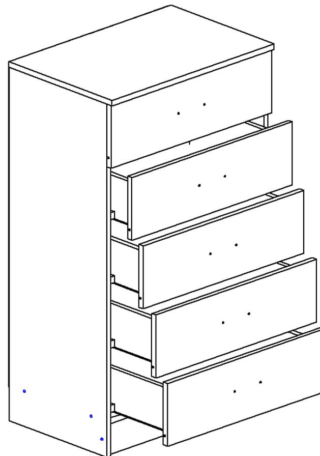
4. Гвоздями 1,2\*20 прибиваем задние стенки ДВП (6), как показано на рисунке. Между двумя листами ДВП (6) ставится соединительный профиль, поэтому прибивать второй лист ДВП нужно после установки этого профиля.
