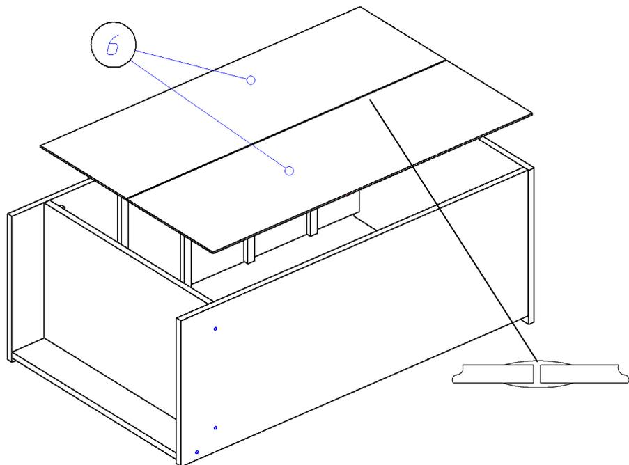
5. Соберем ящики. Евровинтами скрепляем бока ящика (Я.1, Я.2) и панель ящика (Я.3), прибиваем дно ящика ДВП (Я.5) (свес ДВП с незакромлённой стороны 6 мм). С помощью эксцентриковой стяжки крепим фасад (Я.4) к корпусу ящика (ДВП попадает в паз фасада). Прикручиваем с помощью саморезов 3,5\*16 направляющие на ящики.
